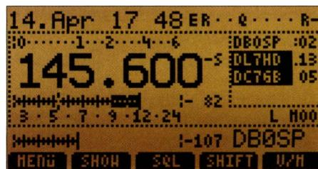
Bild 14: Betrieb mit Anzeige des S-Meters des Relais DB0SP und MH-Liste der STT-Stationen
