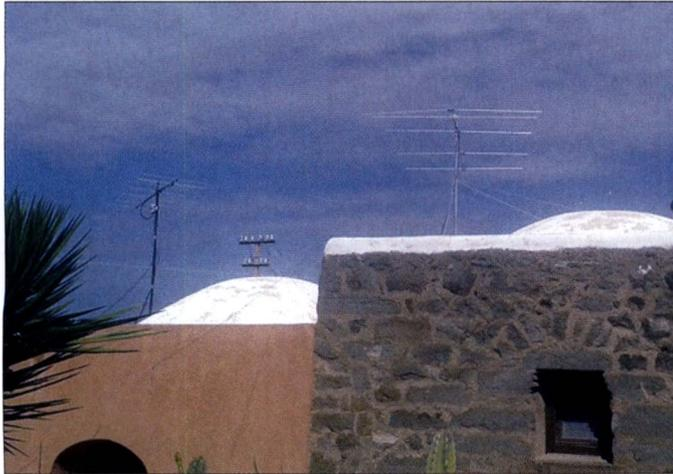
Links die 9-Element-Yagi (2 m), rechts die 5-Element-Antenne (6 m), beide DK7ZB-Design
