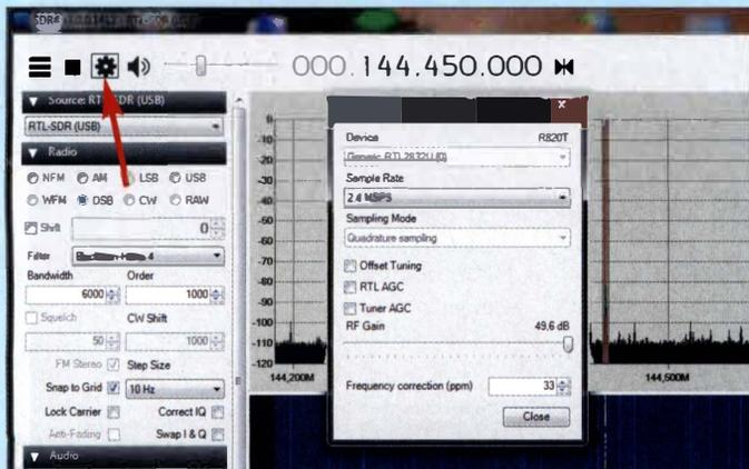
**Bild 14:** Frequenzkorrektur im Einstellungsfenster: durch Variation von *Frequency correction (ppm)* ist das Signal bei eingestellter Sollfrequenz auf nahezu Schwebungsnull zu bringen, was am besten in DSB gelingt.
