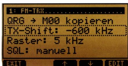
Bild 11: Menü mit vier Auswahlmöglichkeiten zur individuellen Einstellung des Transceivers
