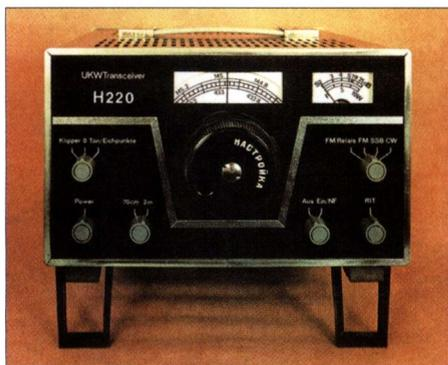
**2-m/70-cm-Eigenbau-Transceiver für CW, FM und SSB von Eberhard Hocke, Y25TL; die Bauanleitung erschien in FA 4 bis 9/1983.**
