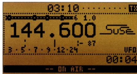
Bild 12: Display beim Senden in FM ohne STT-Betrieb mit Anzeige von  $P_{out}$  und SWW
