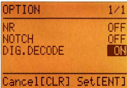
**Bild 5:** Damit der Empfänger bei D-STAR-Empfang Rufzeichen anzeigt, muss die entsprechende Decoder-Funktion aktiviert sein.
