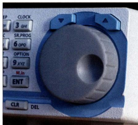
**Bild 2:** Der VFO-Knopf dient zur Frequenzabstimmung, um Speicherinhalte aufzurufen und für Einstellungen im Bedienmenü.
