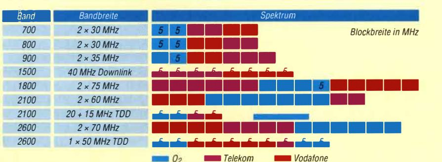
Bild 3: Nach der Auktion resultierende Spektrumaufteilung der drei Mobilfunknetzbetreiber in Deutschland; Zeitduplex (TDD, Time Division Duplex)
