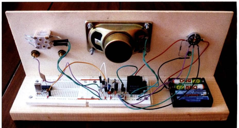
Bild 5: Versuchsaufbau des MW-Radios mit UKW-Konverter
