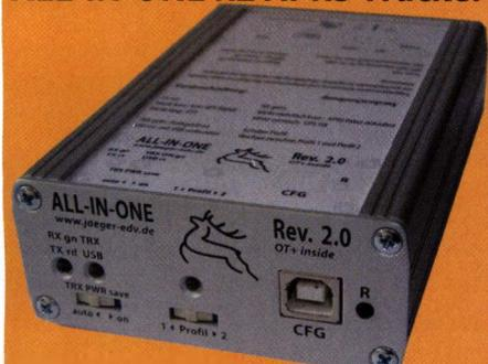
**Mobil Tracker** 124/82/35 mm (L/B/H) zum Übermitteln des Standorts in das APRS Netz. Integrierter 2m / 70cm TRX mit 5W und GPS Empfänger SIRF starIV. Konfiguration über USB Port. Der ALL-IN-ONE R2 Tracker wird durch einen Opentracker+ mit 2 Profilen und weiteren Features gesteuert. Profilwechsel durch Schalter. Trigger gesteuerte Aktivierung und zeitgesteuerter Nachlauf von 45 Min. mit anschließender kompletter Abschaltung des Trackers bis zum nächsten Trigger Impuls.
